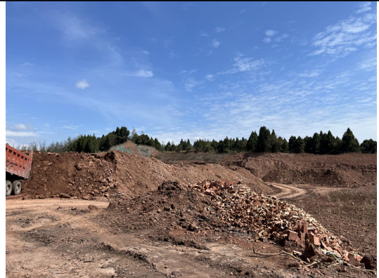
图 2 页岩原辅料露天堆放未遮盖
